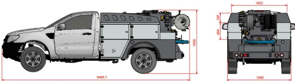
L'UrbanCombi 2.1 è dotato di cassette di contenimento basse per il trasporto di tubi di aspirazione più lunghi.
