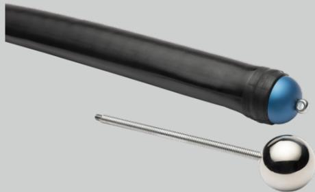
**Picote Bendi Packer** wurden speziell für Reparaturen in Bögen entwickelt, funktionieren aber auch auf geraden Rohrstrecken hervorragend! Die Packer dehnen sich zuerst von der Mitte aus. Das sorgt für ein faltenfreies Endergebnis. Dank des innovativen und patentierten Frontantriebssystems, das an der Stirnseite des Packers seine Wirkung ausübt, können Sie den Packer längere Strecken und durch mehrfache 90°-Bögen manövrieren.
